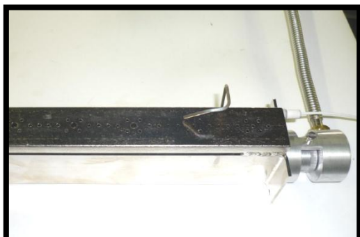
Détail du système de contrôle de flamme Brûleur rampe ornemental.
