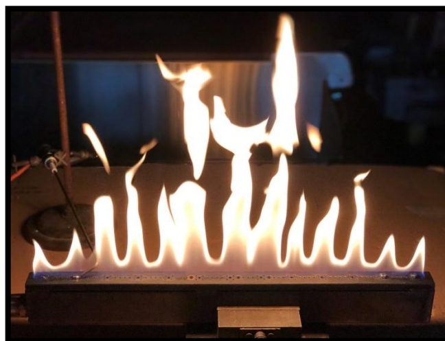
Brûleur rampe ornemental de longueur de 500mm en gaz naturel à 20mbar.
