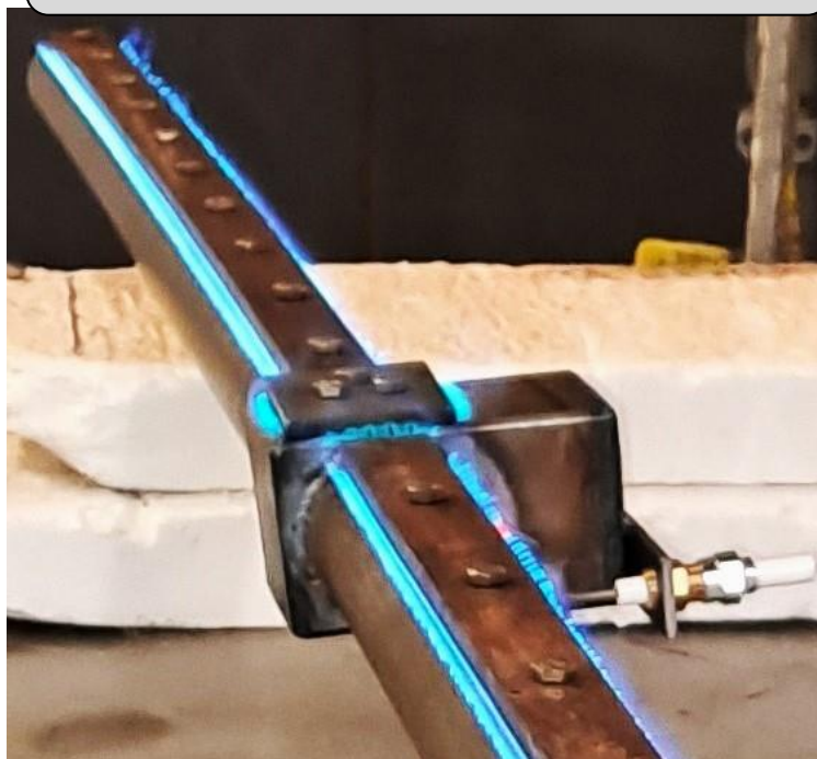
Détail de l'élément rampe de flamme avec injection air/gaz centrale
