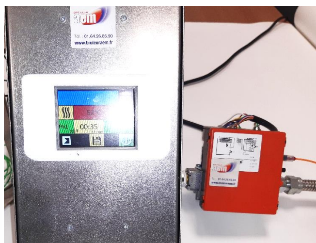
Carte de régulation ET35ATBP Verticale pour commande et régulation d'1 ensemble de brûleurs.
