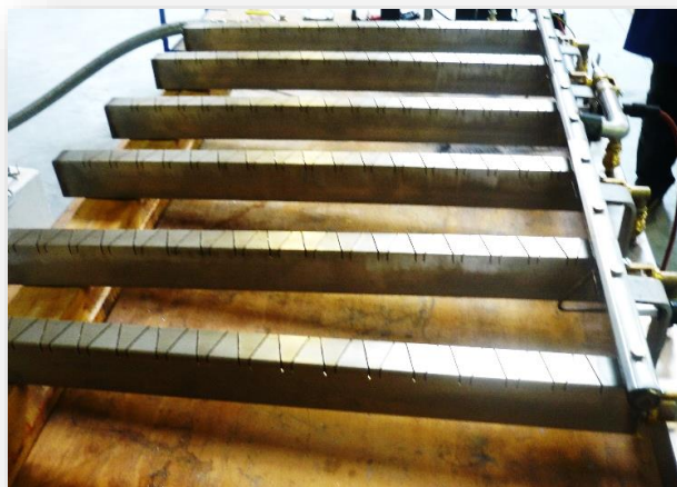
Ensemble 6 brûleurs rampe compact avec veilleuse linéaire en gaz naturel 20mbar.
