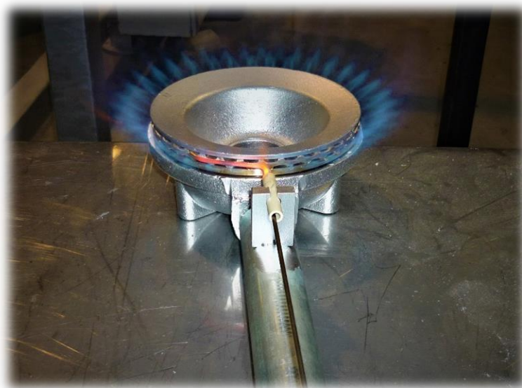
Tête de flamme Modèle 880, avec électrode de contrôle de flamme.
