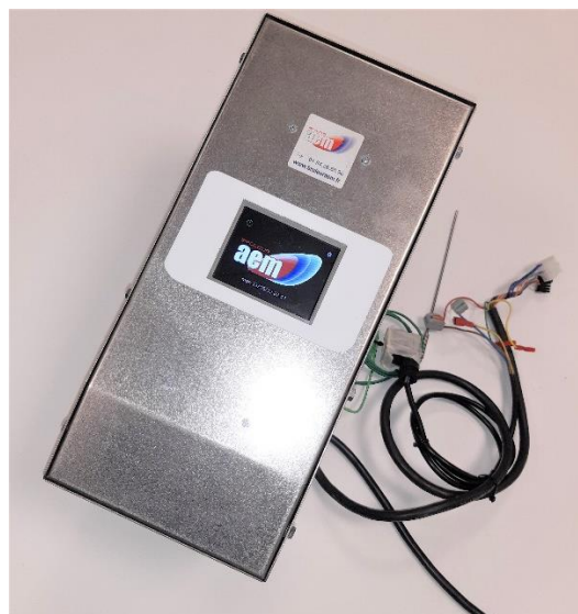
Carte écran de commande et de régulation de température ET35ATBP vertical.
