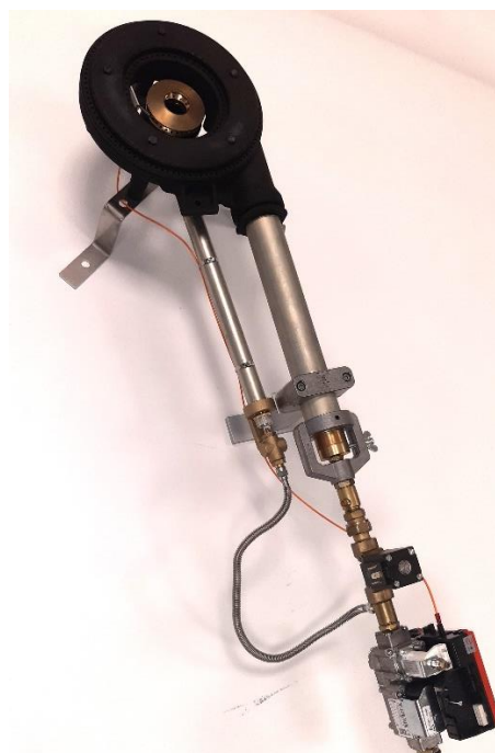
Brûleur FV240-21 équipé d'un brûleur central pour le fonctionnement booster et une régulation PID.
