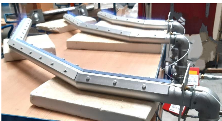
3 Brûleurs rampe ASBP, en tube Ø 48mm de forme elliptique à plat en fonctionnement en propane 40mbar.
